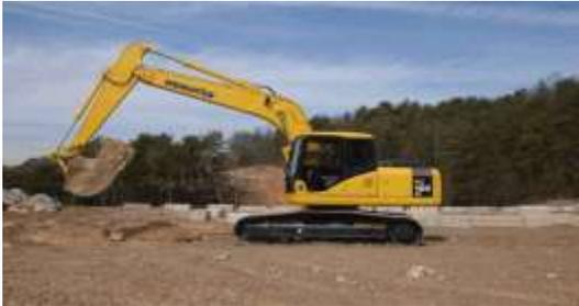
**Figure VIII.2: Pelle hydraulique Équipée en rétro**
