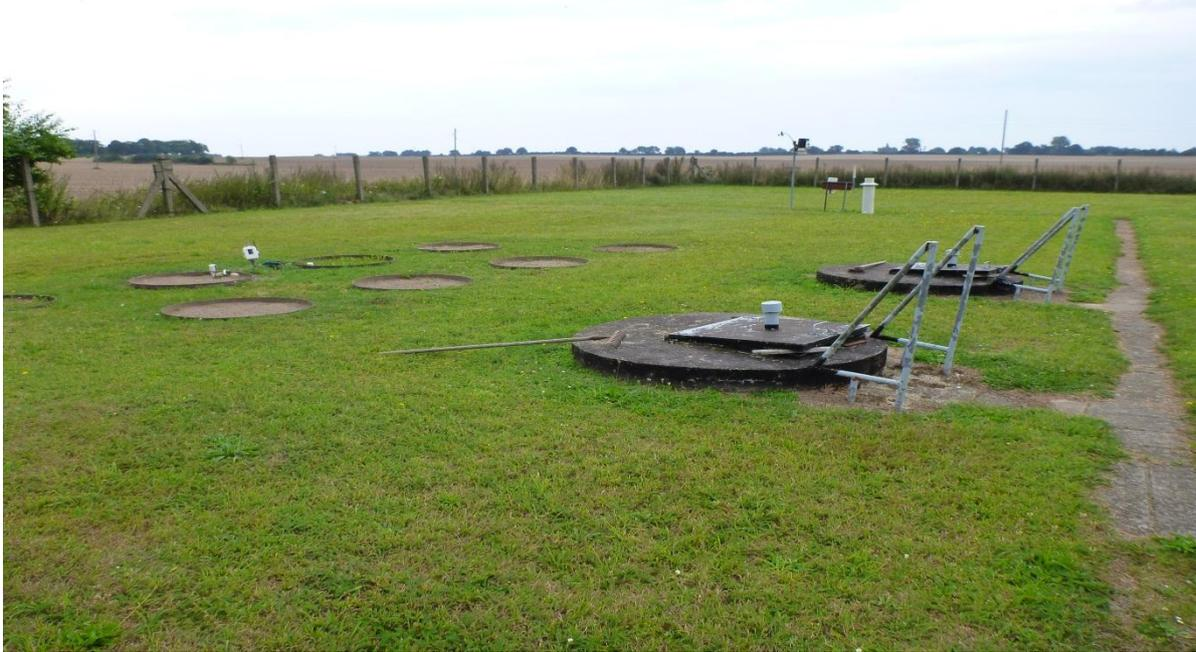
**Figure III.2: L'évapotranspiromètre**
