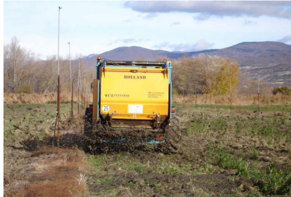
Figure IV-4 : Epannage de boues pâteuses
