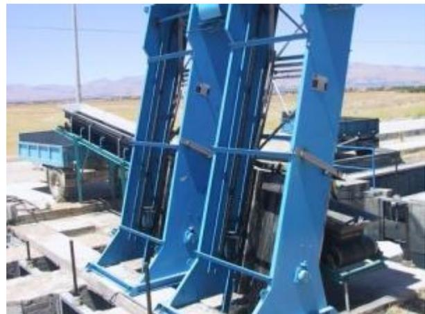
Figure II.3 Dégrilleur à grilles droites par chaîne sans fin
