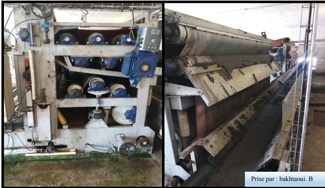
Figure III- 25 : Appareil presse à bande.
