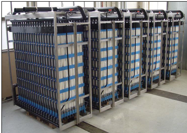
Figure 27 Bioréacteur à membrane assemblé en cassette source : Aqua-Aerobic Systems
