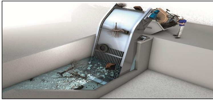
Figure 8 Ouvrage de dégrillage
