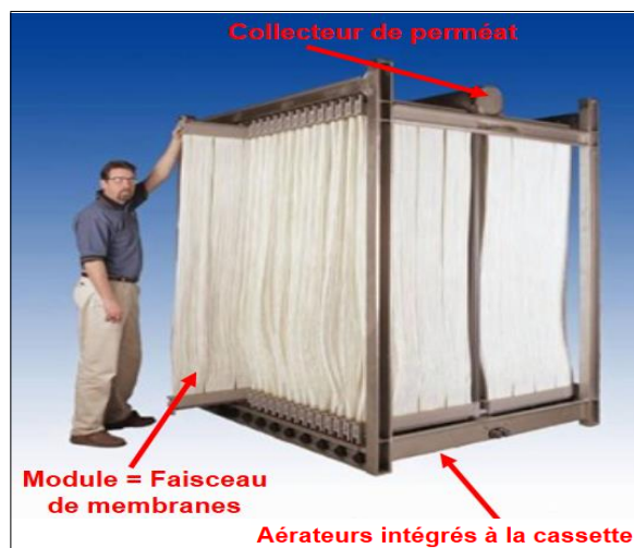
Figure 55 Assemblage en cassette du BRM (SUEZ)
