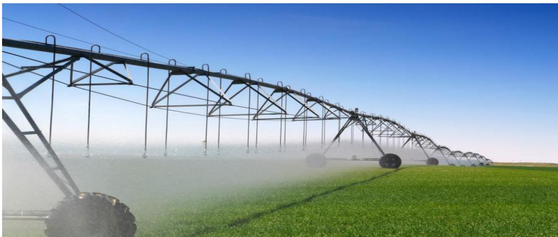
Figure.III.4 : Arrosage par pivot
