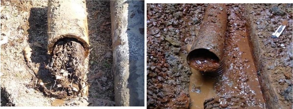
Fig.VII.1 : Colmatage des drains
