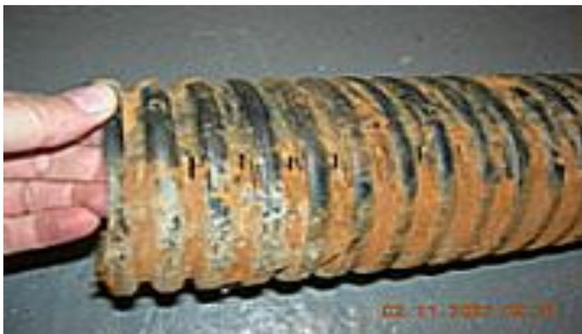
Fig.VII.2 : Colmatage ferrique des orifices d'un drain
