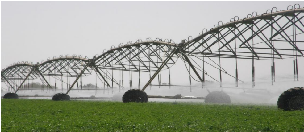
Figure 14: Système d'irrigation utilisant un pivot central.
