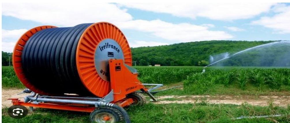
Figure 13: Système d'irrigation par enrouleur.
