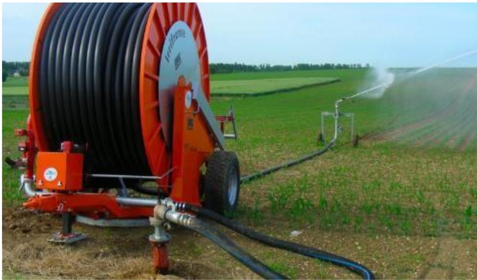
Figure V.2 : Système d'irrigation par enrouleur
