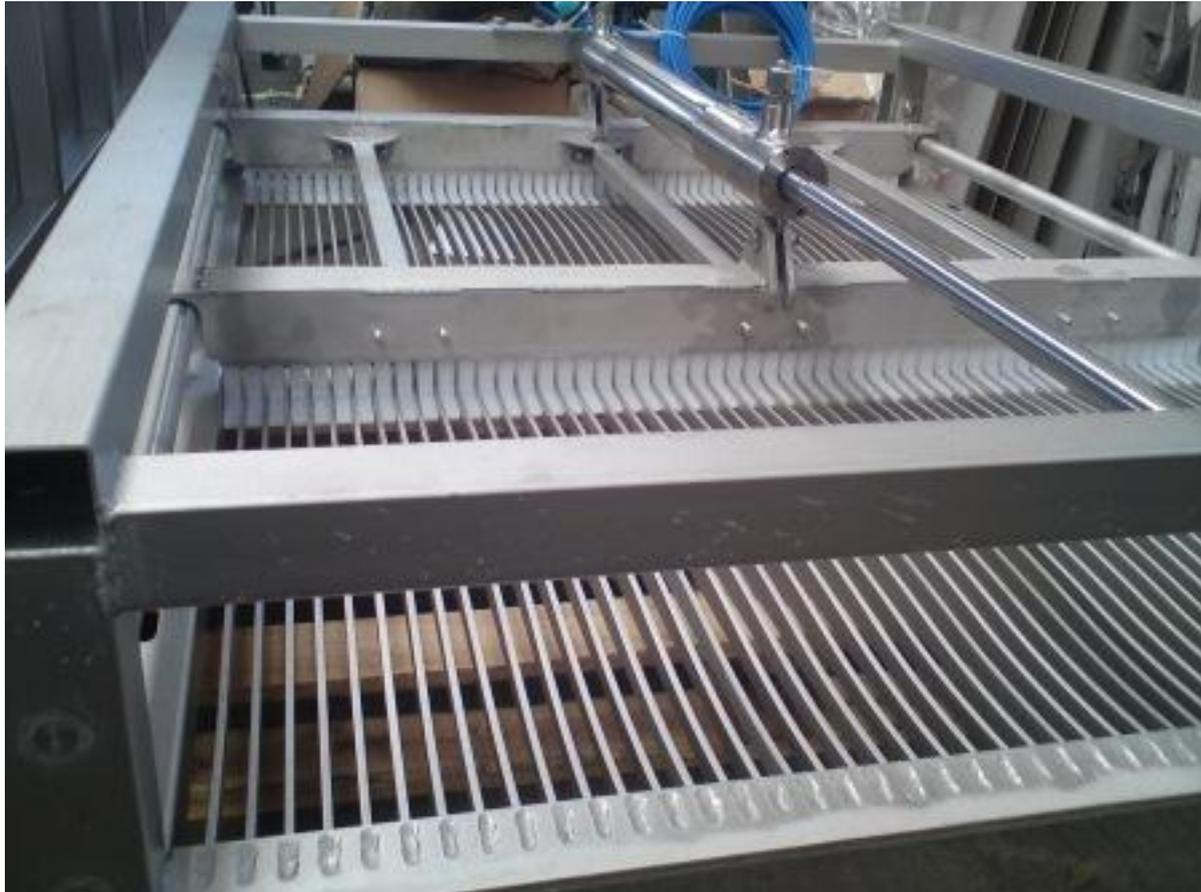
Figure I.2: Dégrilleur mécanique (source : [www.hellopro.fr](http://www.hellopro.fr))
