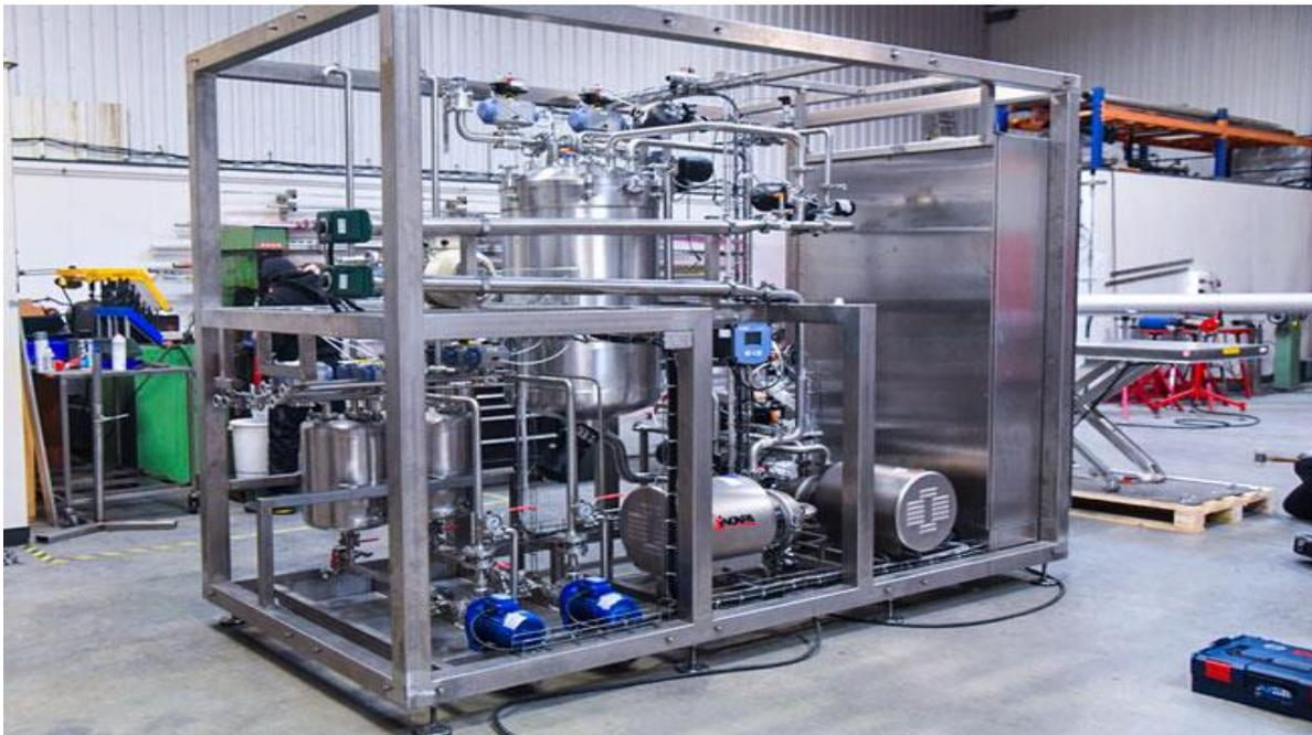
Figure II.6 : La machine NEP de la laiterie EL-AMIR « nettoyage en place »
