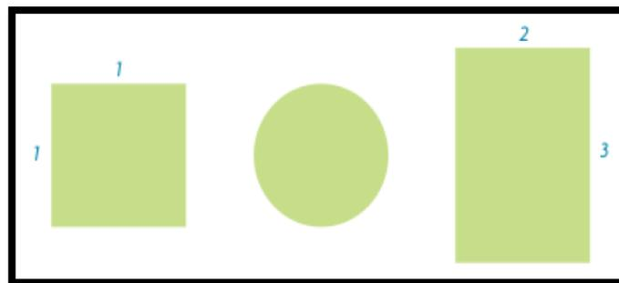
Figure III-4: Les formes possibles des filtres verticaux.
