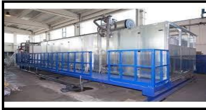
Figure II.10 : Unité avec filtre charbon actif série modulaire pour élimination des odeurs
