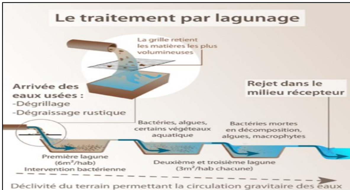
Figure I.9 : principe de fonctionnement du lagunage.
