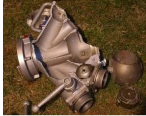
Figure 4 : Division à cinq sorties détruite par un coup de bélier
