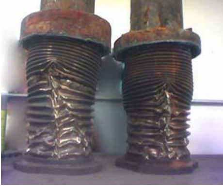
Figure 3 : Joints d'expansion détruits par les coups de bélier
