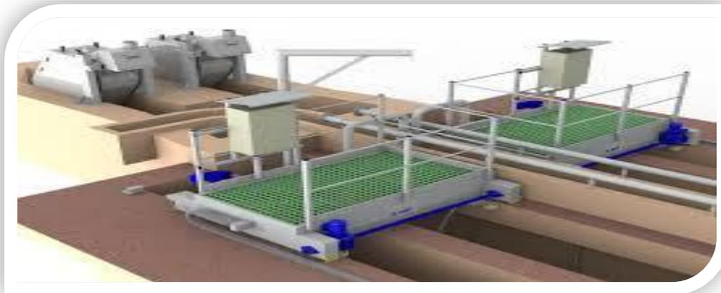
**Figure III.2 :** schéma synoptique d'un dessableur couloir. [7]
