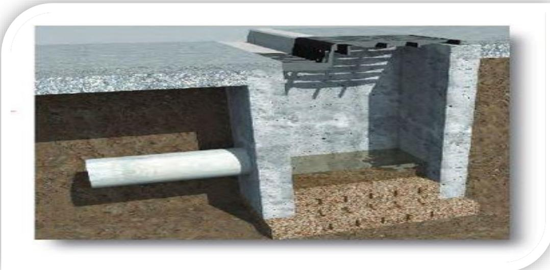
**Figure V.2** : Bouche d'égout à puisard (source : Référentiel ouvrages du Grand Lyon)
