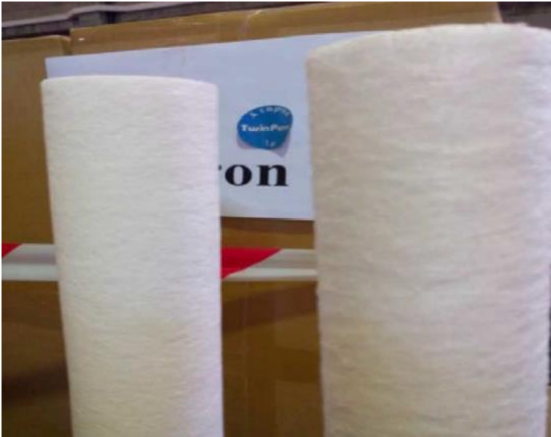
Figure III-5: L'unité des filtres à cartouches.
