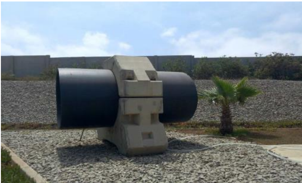
Figure III-1: La conduite en PEHD.
