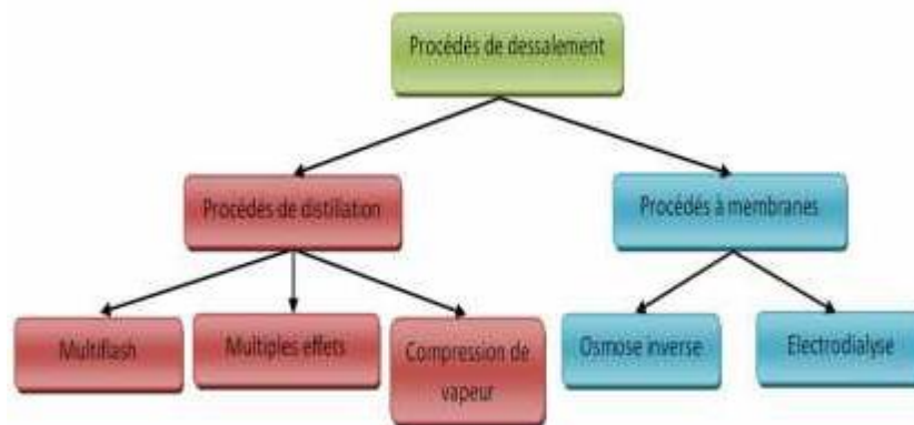
Figure II-1: Les différents procédés de dessalement.
