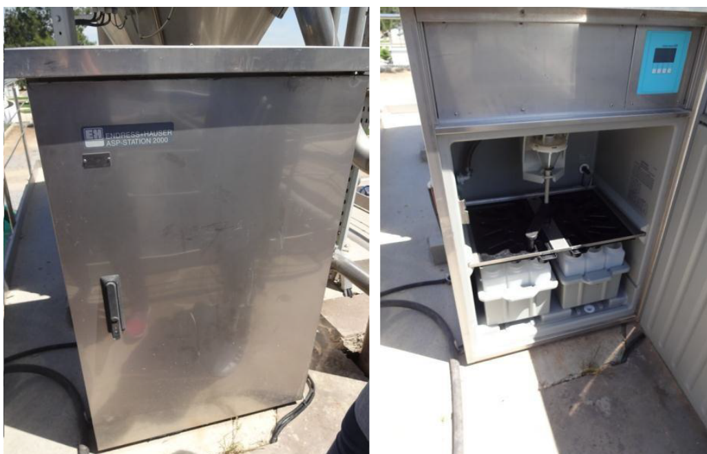
FIGURE 4.2 – Échantillonneur automatique de la STEP de Béni Mered
