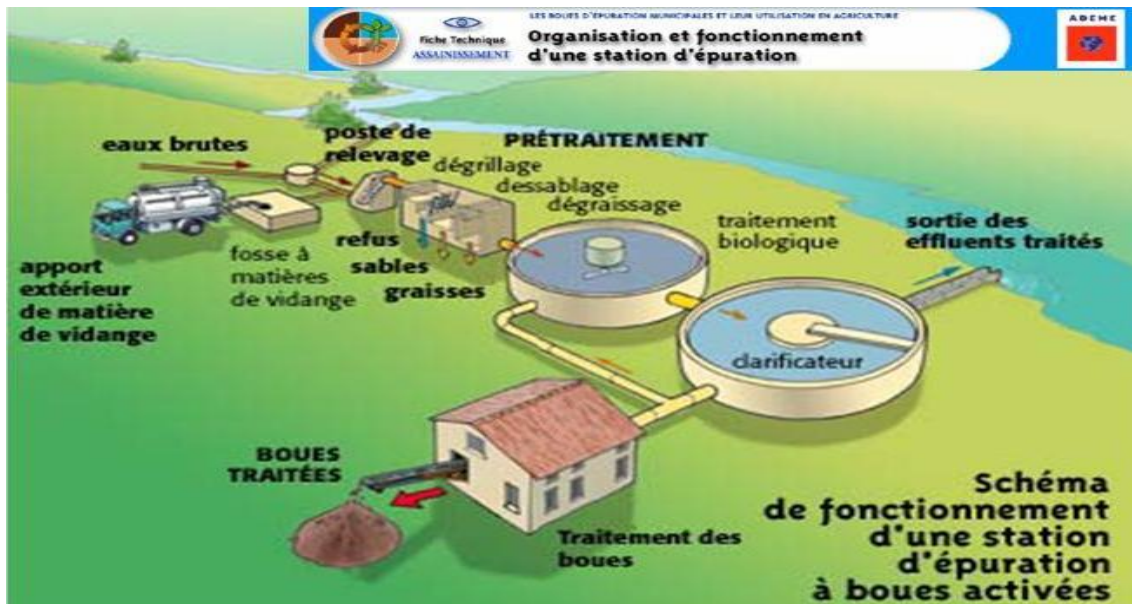
Figure_I_08 : schéma de fonctionnement d'une STEP à boues activées.
