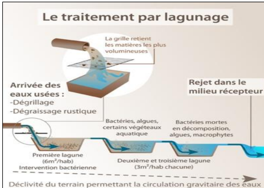
Figure_I_06 : le traitement par lagunage.
