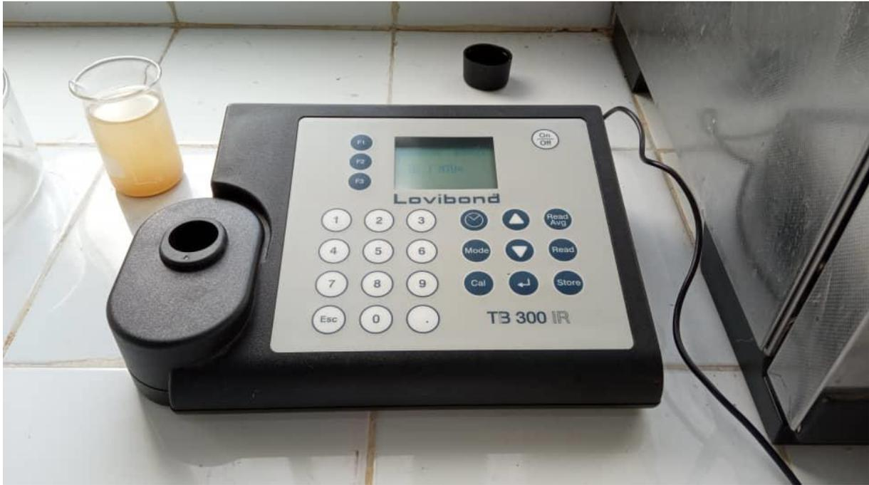
**Figure 19 Turbidimètre de type lovibond**
