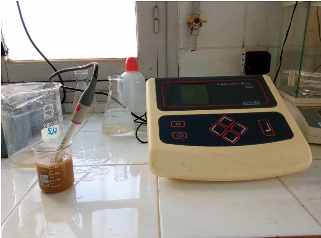
**Figure 18 Représente le conductimètre de type JENWAY**
