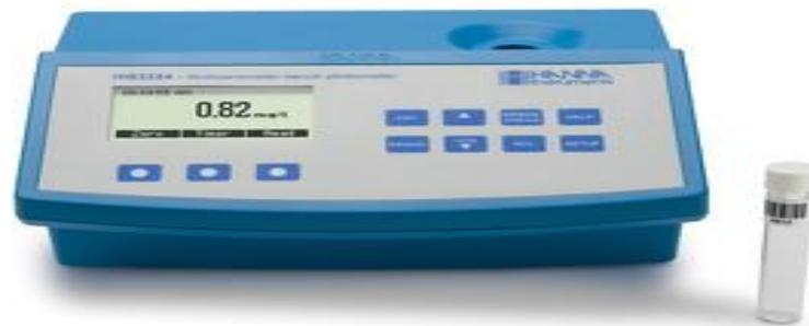
**Figure VI.1 :** Photomètre DCO/eaux usées, avec lecteur de code-barres
