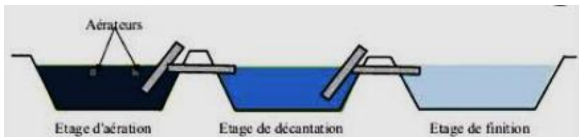
Figure III-16 : Schéma de principe d'un lagunage aéré
