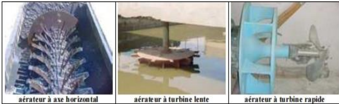
Figure II. 7: Les différents de mobiles d'aération. [11]
