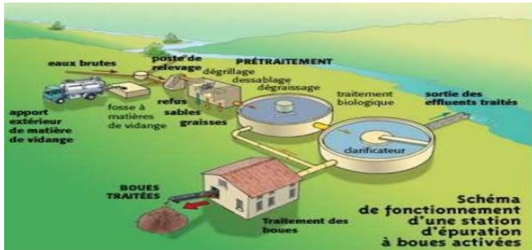
Figure II. 6 : Schéma de fonctionnement d'une station d'épuration à boue activées. [15]
