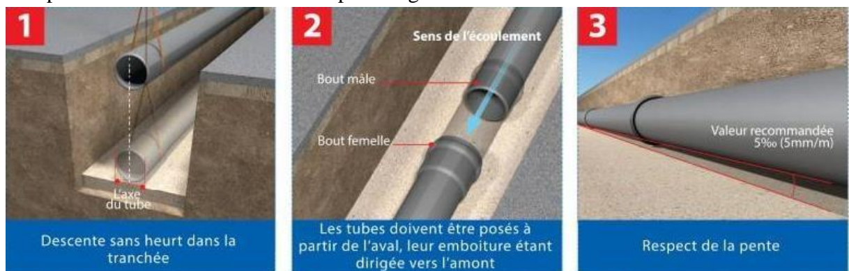
Figure VII.2 : Pose des canalisations (Source : Groupe Chiali)
