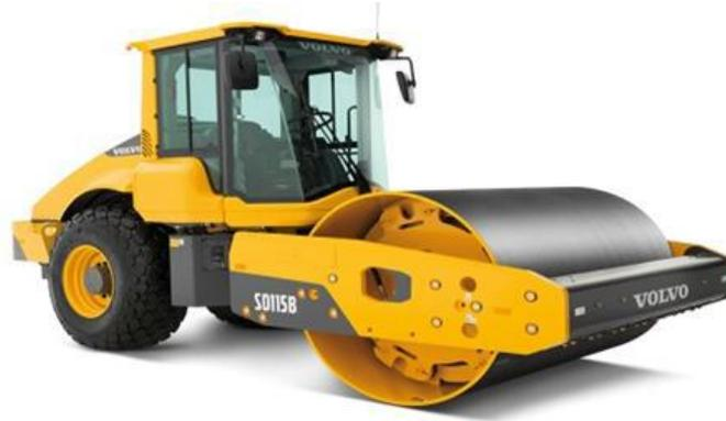
Figure VII 6 : Compacteur à rouleaux lisses
