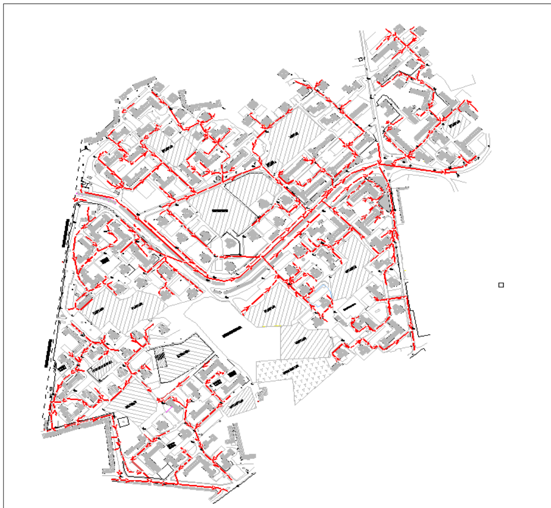
Figure III-1 : Réseau d'assainissement existant de la cité 8 mai 1945 [ 1 ]
