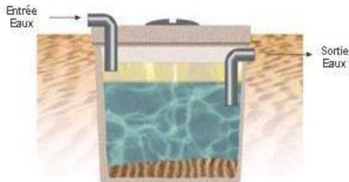
Figure 13: Principe de fonctionnement Un dégraisseur-déshuileur combiné
