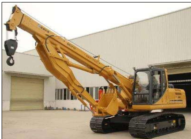
Figure VII-2 : Engins de pose de conduites (Pipelayers).
