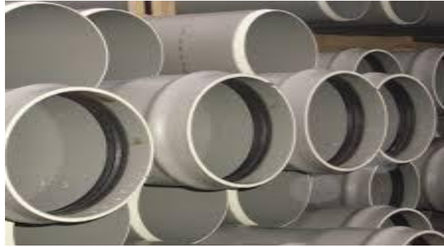
FigureVI.03 : Conduite en PVC
