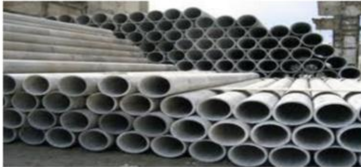
Figure VI.02 : Conduite en amiante ciment
