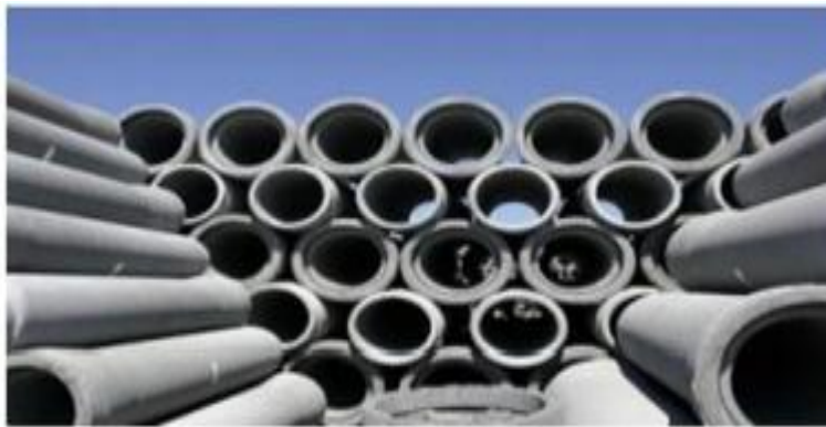
Figure VI.01: Conduites en béton non armé.
