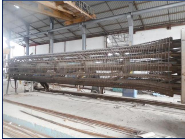
**Figure VI-3 : fabrication d'un tuyau en béton armé avec centrifugation (Source : Usine TRANS CANAL Centre S.P.A)**
