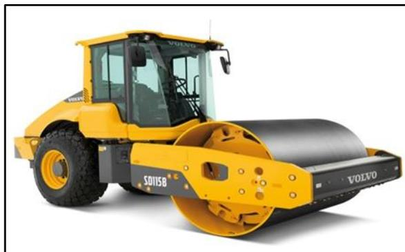
Figure VII-6 : Compacteur à rouleaux lisses
