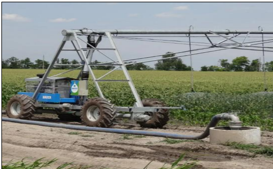
Figure VII.2 : Pivot canal avec conduite sous pression.
