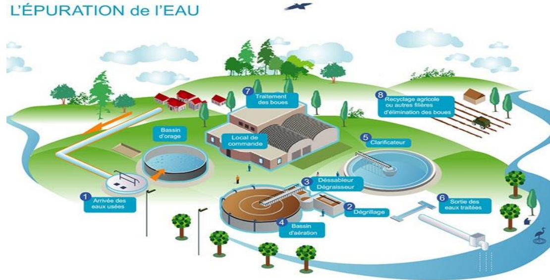
Figure.I.01 : comment fonctionne une station d'épuration
