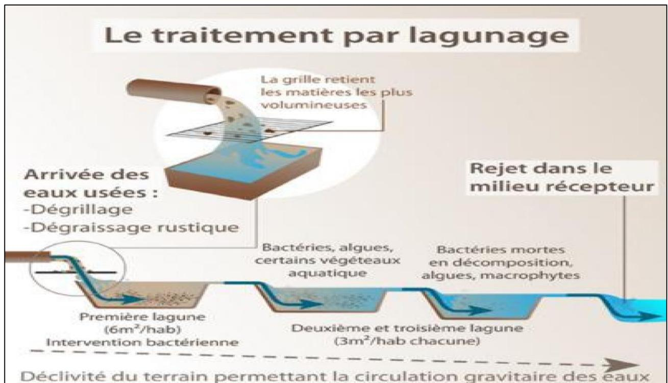
Figure II.1 : principe de fonctionnement du lagunage. [13]
