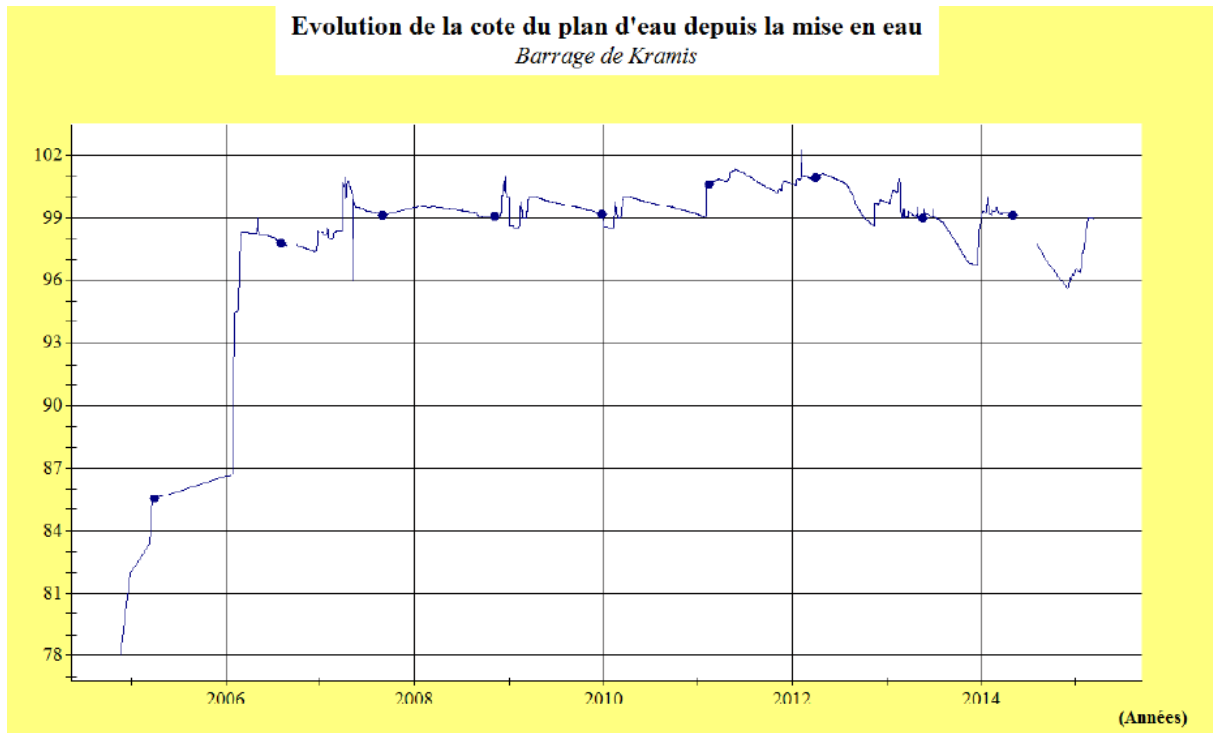
Figure II. 4 : Evolution de la cote du plan d'eau depuis la mise en eau (ANBT, 2015).
