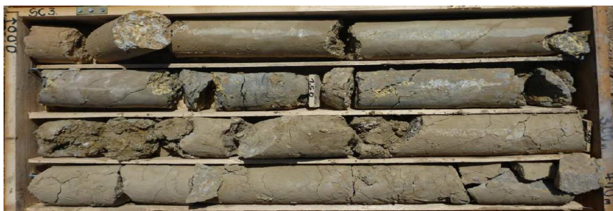
Figure IV. 1: Sondage carottés SC3 (0 à 4 m), (ANBT, 2015)
