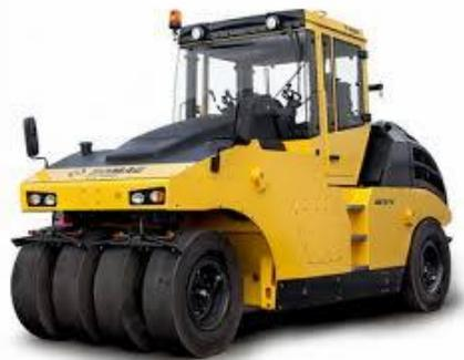
**Figure VII.2** Compacteur à pneus
