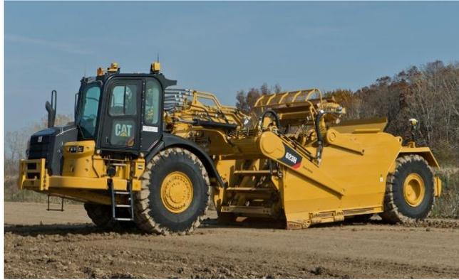
**Figure VII.5 :** Décapeuse automotrice
