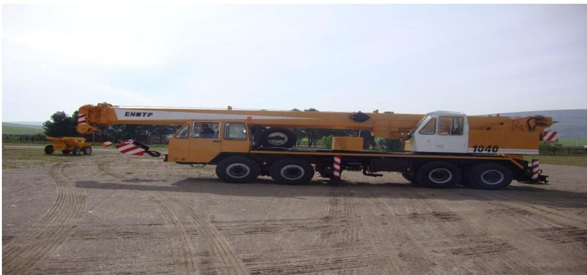
Grue automotrice pour soulever, déplacer et déposer.
