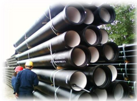
Figure .V.3.conduite en Font
