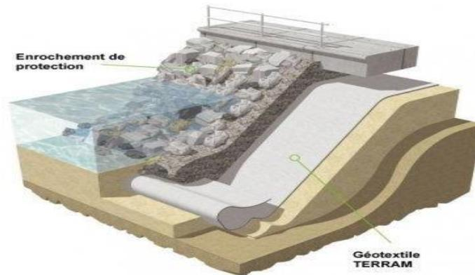
**Figure. IV.3 :** Revêtement en enrochement avec une transition en géotextile
