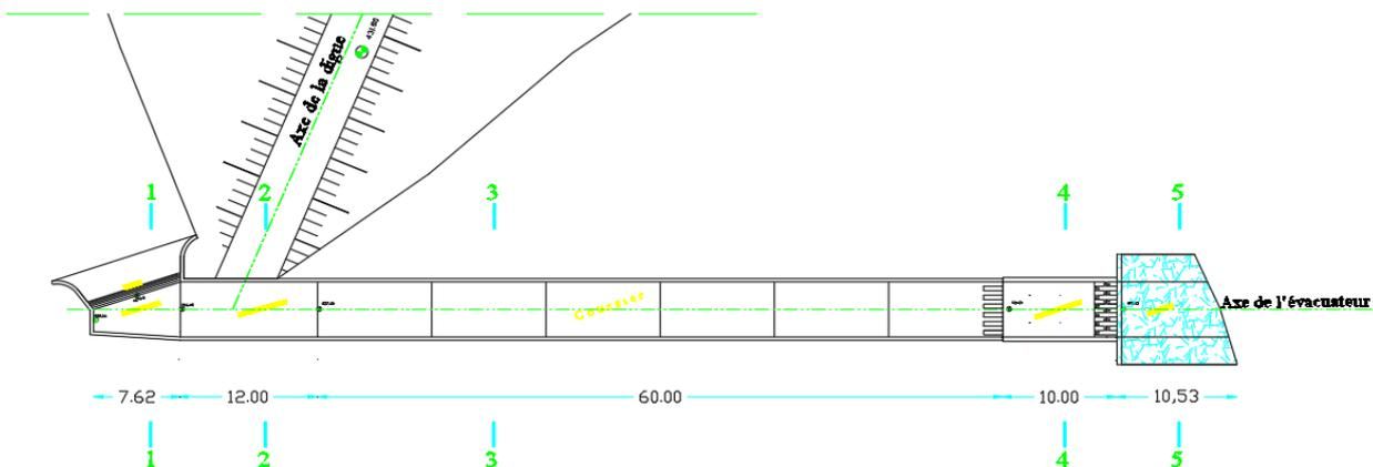
**Figure. V.1** : Schéma général d'un évacuateur latéral à entonnement latéral
