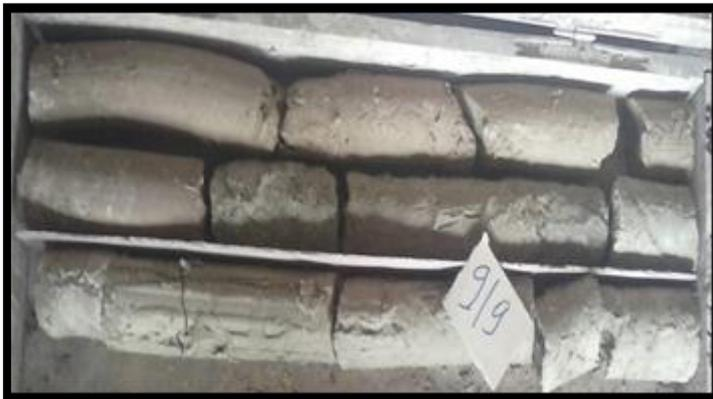
**Figure IV.4 :** Echantillon prélevé du sondage n° 02 (Profondeur 5.0 – 10.0 m)
