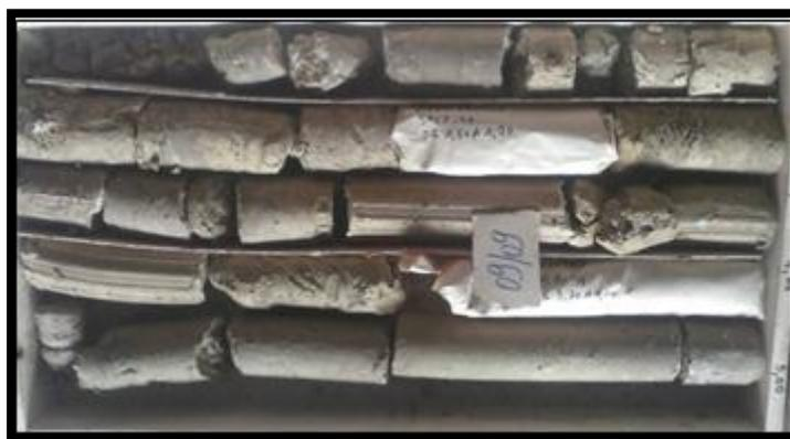
**Figure IV.1** : Echantillon prélevé du sondage n° 01 (Profondeur 0.0 – 5.0 m)
