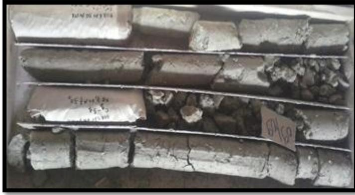
**Figure IV.2 :** Echantillon prélevé du sondage n° 01 (Profondeur 5.0 – 10.0 m)
