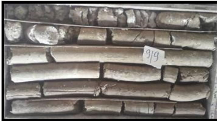
**Figure IV.3 :** Echantillon prélevé du sondage n° 02 (Profondeur 0.0 – 5.0 m)
