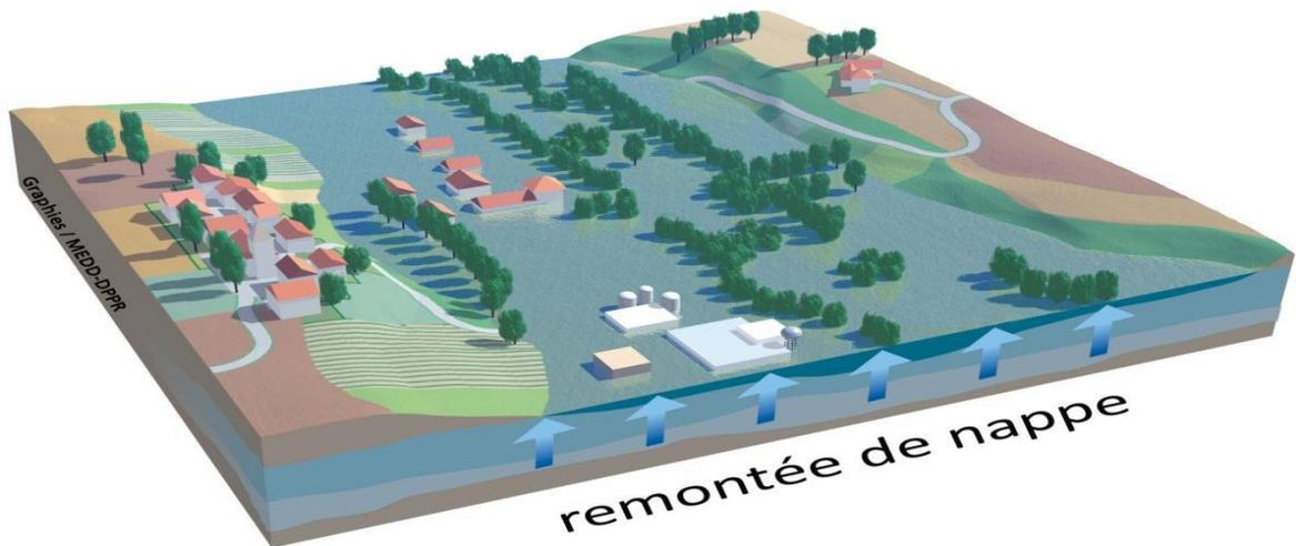
**Figure 7 :** inondation par la remontée de nappe.
