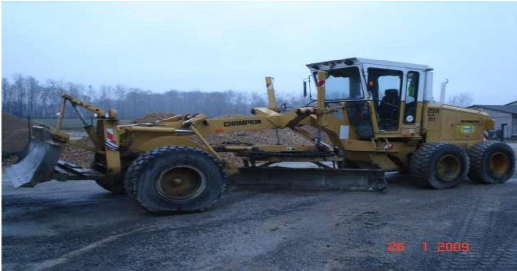
**Figure 1 :** Niveleuse automotrice .
