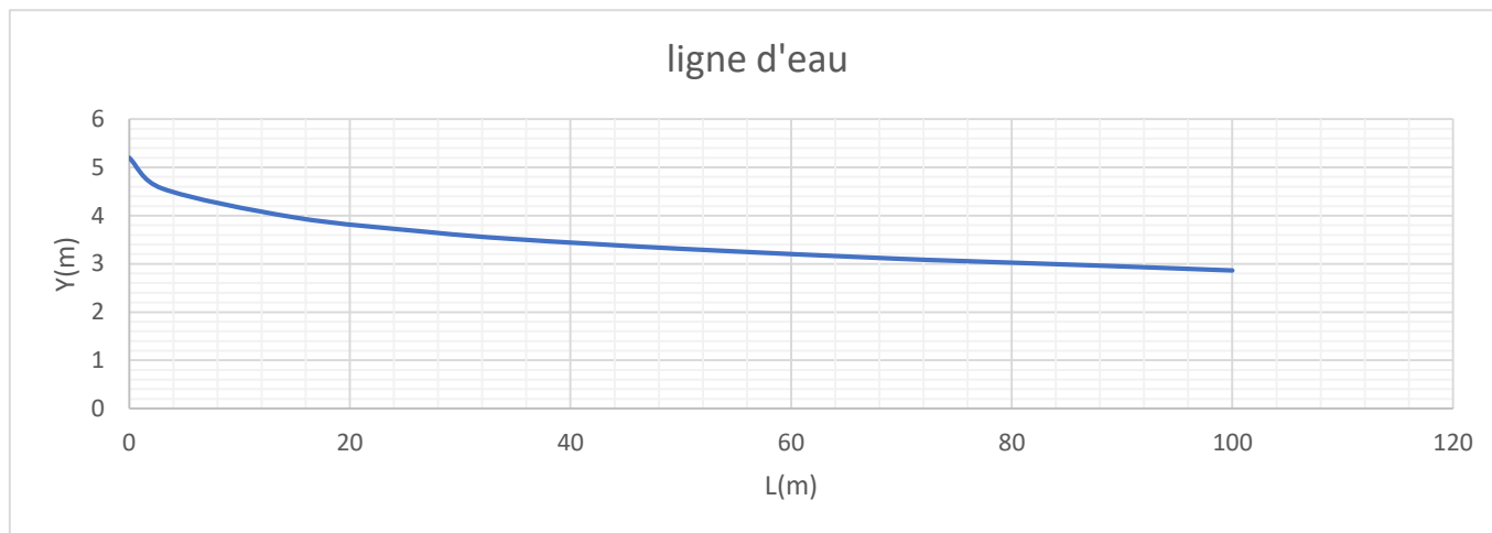
Figure IV.06 : ligne d'eau du coursier (type S2).
