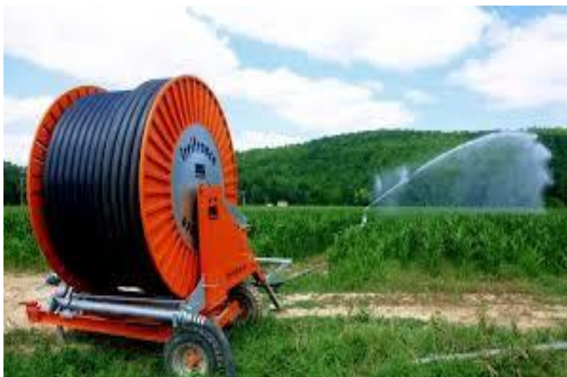
Figure V.2: Irrigation par enrouleur.
