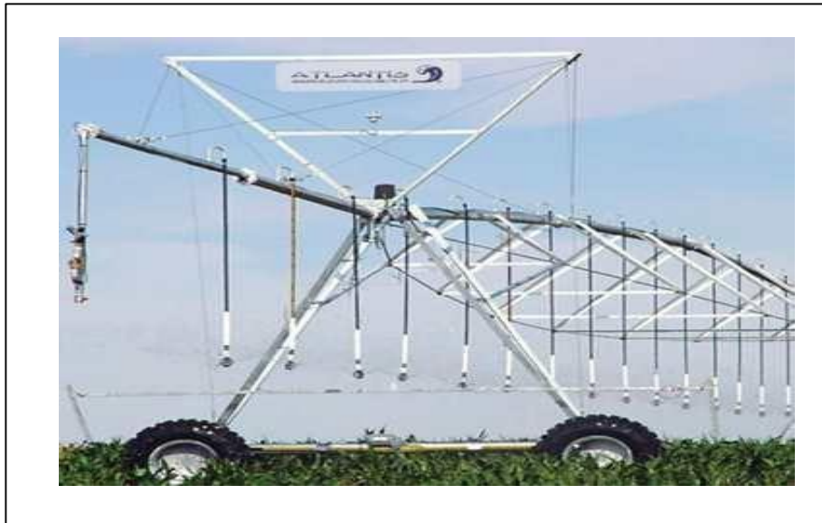
Figure V.4 : Porte-à-faux de rampe d'irrigation.
