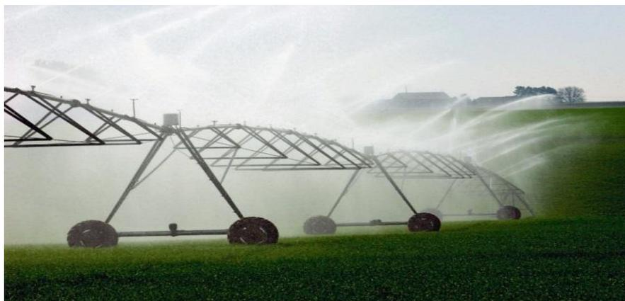
**Figure VI.5** Aspersion mobile (par pivot)
