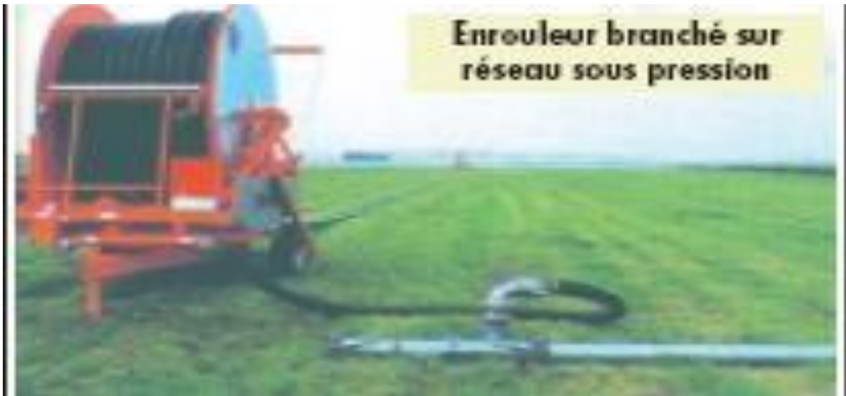
Figure 26 : Enrouleur branché sur réseau sous pression.
