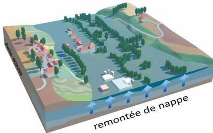
Figure 4 : Remonter de la nappe phréatique.
