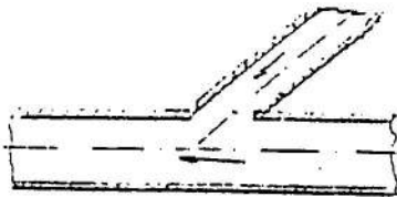
point de raccordement avec inclinaison
