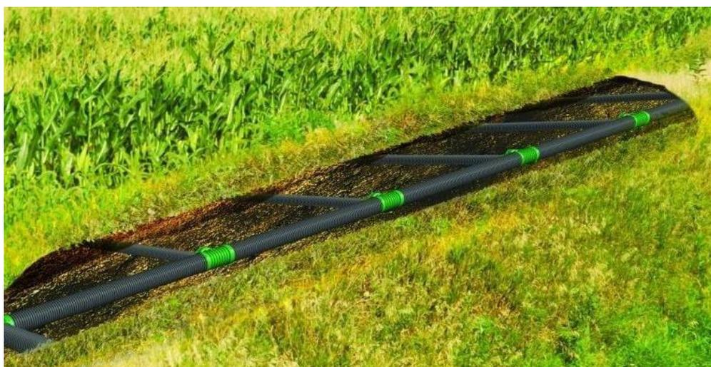
**Figure 28** : Raccordement entre drain et collecteur.
