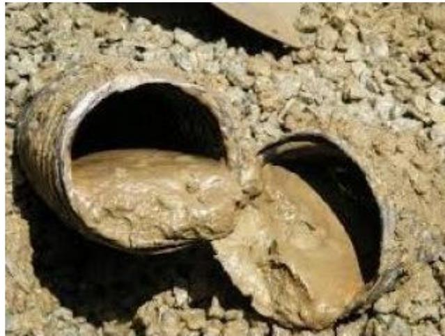
**Figure 31 :** Colmatage des drains
