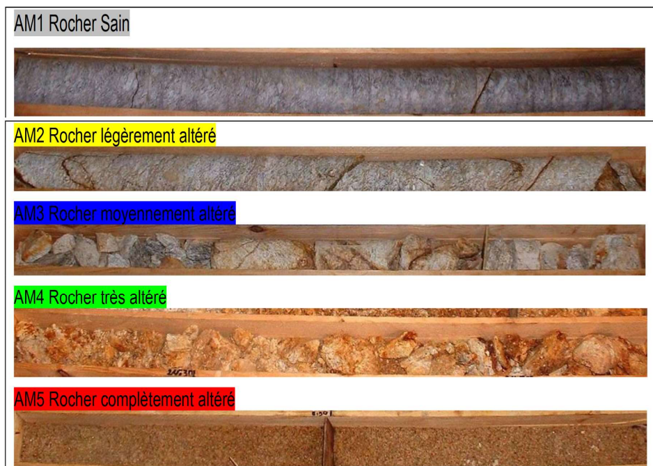
Figure II.4 : Exemples des classes d'altération AFTES AM1 à AM5 dans les sondages (APD)
